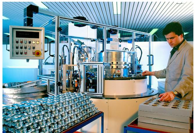
Abb. 1: Ergänzend zur Einzelprüfung werden auch Messungen auf einem Reihenprüfstand vorgenommen, bei dem jedes Gerät auf zulässige Toleranzen getestet wird.
